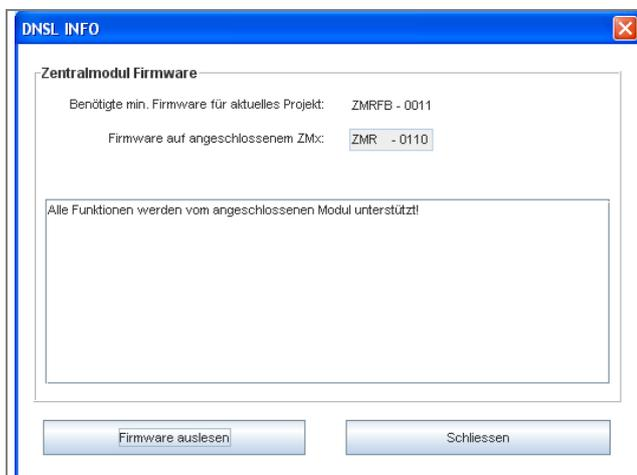
Hier erhalten Sie Informationen zur Firmware des angeschlossenen Zentralmoduls. Sollten Sie Funktionen ausgewählt und/oder platziert haben welche von der Firmware nicht unterstützt wird, werden diese aufgelistet.
