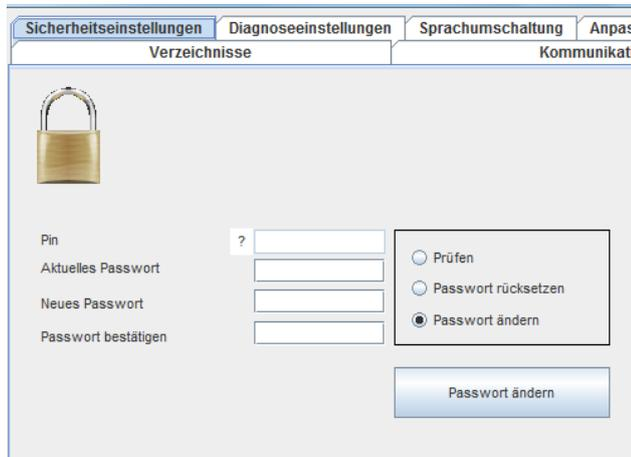
Es besteht die Möglichkeit das Zentralmodul mit einem Passwort zu schützen. Das Passwort kann 4 oder 6 Stellen haben. Ist die Passwortfunktion aktiviert, so ist das Übertragen einer Applikation nicht mehr möglich, ohne vorherige Eingabe des richtigen Passwortes. Beim Auslieferungszustand ist das Passwort auf „0000“ gesetzt, was bedeutet dass die Passwortfunktion deaktiviert ist.
